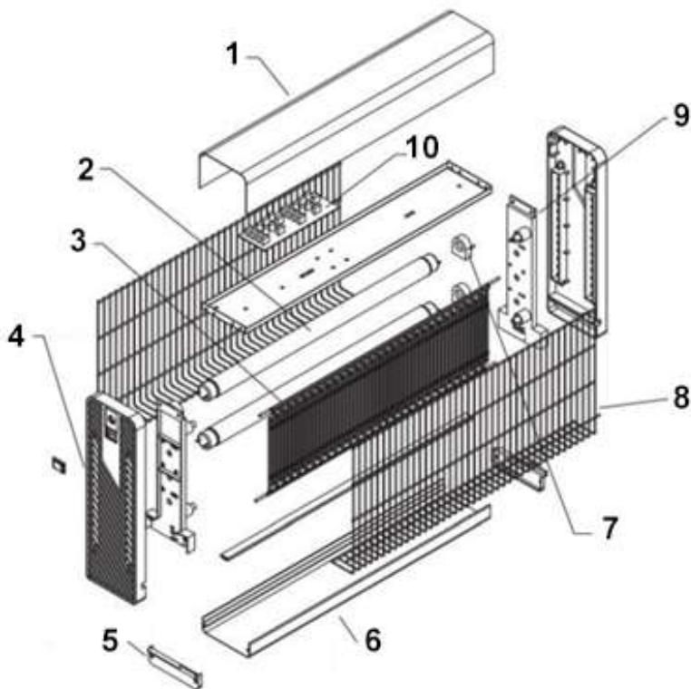
1 = Coperchio superiore | 2 = Lampade | 3 = Griglie ad alta tensione | 4 = Coperchio laterale | 5 = Blocco di fissaggio del cassetto | 6 = Cassetto di raccolta | 7 = Portalampara | 8 = Griglie esterne | 9 = Struttura laterale | 10 = Elevatore di tensione
