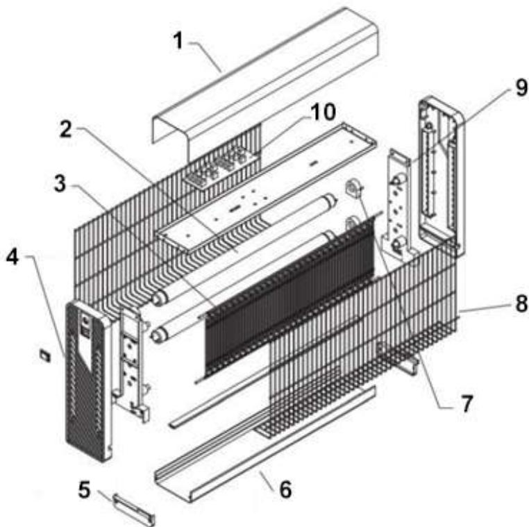
1 = Tapa superior | 2 = Lámparas | 3 = Rejillas de alta tensión | 4 = Tapa lateral | 5 = Bloqueo de fijación del cajón | 6 = Cajón de recogida | 7 = Portalámparas | 8 = Rejillas externas | 9 = Estructura lateral | 10 = Elevador de tensión
